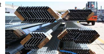
Acier laminé à froid est galvanisé par une immersion continue à chaud
